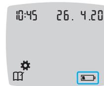
El medidor funciona con normalidad, mostrando el símbolo **Pila baja** hasta que sustituya las pilas.
