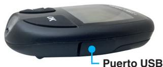
Asegúrese de que la tapa del puerto USB de su medidor está completamente cerrada cuando no lo utilice.
