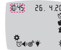
4. Pulse el botón **OK** cuando la hora actual esté parpadeando en la pantalla **Configuración**. El formato de la hora parpadea.
