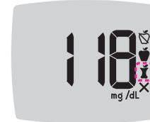
Ejemplo: Si se desplaza hacia abajo hasta **Después de comer**, el marcador **Después de comer** parpadea.
