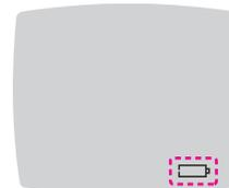
Cuando ya no pueda realizar un análisis debido a que las pilas estén casi descargadas, el medidor mostrará la pantalla **Pila agotada**. Sustituya las pilas inmediatamente.
