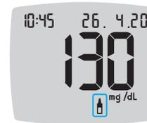
El medidor realiza una cuenta regresiva de 5 segundos antes de mostrar el resultado del análisis de control. El medidor marca automáticamente el resultado como un análisis de control.
