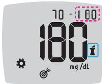
9. Para cambiar la indicación **Alto** que parpadea en el **Intervalo objetivo Después de comer**, pulse el botón ▲ o ▼.
