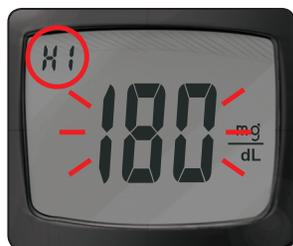
Ahora destellará la configuración glucémica HI (el valor predeterminado es de 180 mg/dL). Para cambiarla, pulse ▲ o ▼ hasta llegar a la configuración HI deseada. Pulse **M** para confirmar. (El intervalo de valores HI es de 100 a 250 mg/dL).
