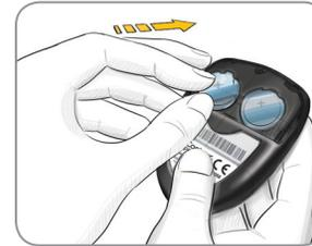
4. Coloque las baterías nuevas debajo de las lengüetas y dentro del compartimiento de las baterías con el signo “+” hacia arriba. [Utilice dos baterías de litio de 3 voltios (DL2032 o CR2032).]
