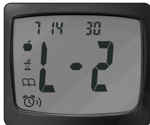
Si seleccionó el Modo avanzado (L-2 aparece en la pantalla), puede cambiar la configuración de los valores de glucosa en sangre bajos y altos personales de su medidor. Al personalizar estas configuraciones, el medidor CONTOUR®PLUS le ayudará a llevar registro de sus resultados HI y LO.
