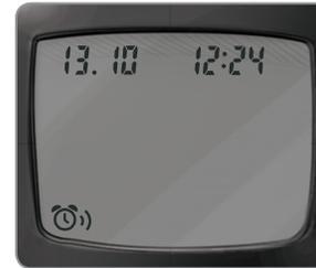
Cuando el medidor esté apagado, pulse **M** para encender el medidor. La fecha y la hora aparecerán junto con el símbolo
