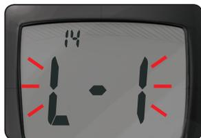
Después de configurar el sonido, destellará **L-1**. Para mantener el medidor en el Modo básico, pulse **M** para confirmar. Para cambiar el medidor al Modo avanzado, pulse **▲** o **▼** para cambiar a **L-2**, y pulse **M** para confirmar.
