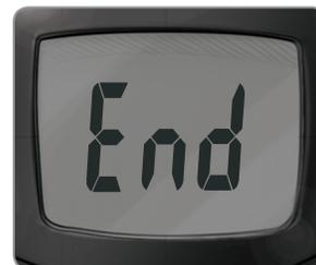
Pulse de nuevo **▲** y verá **End**. Pulse **M** para apagar el medidor, o este se apagará automáticamente después de 3 minutos.
