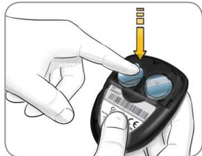
3. Retire las baterías viejas presionando la parte superior de cada batería para elevar la parte inferior de esta.
