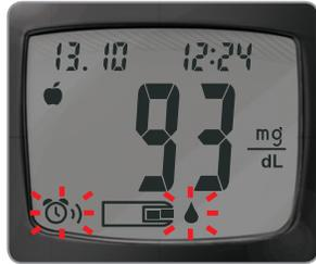
Cuando suene el recordatorio, el medidor se encenderá automáticamente. El recordatorio sonará 20 veces y la pantalla mostrará el resultado del análisis previo a la comida que usted marcó al configurar el recordatorio. Pulsar cualquier botón silenciará el recordatorio.
