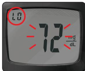
La configuración LO destellará (el valor predeterminado es de 72 mg/dL). Para cambiar esta configuración, pulse ▲ o ▼ hasta llegar a la configuración LO deseada, y luego pulse **M** para confirmar. (El intervalo de valores LO es de 60 a 90 mg/dL).
