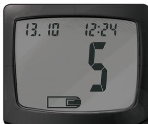
10. El medidor hará un cuenta atrás de 5 segundos y el resultado del análisis de control aparecerá en la pantalla del medidor.
