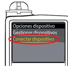
8. En el menú **Opciones dispositivo**, desplácese hasta **Conectar dispositivo**. Pulse el botón Seleccionar Ⓞ.
