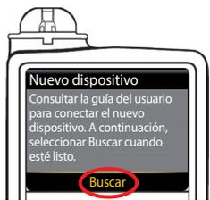
11. Coloque el medidor y la bomba uno al lado del otro. Seleccione **Buscar** en la bomba. Seleccione **Buscar** en el medidor.
