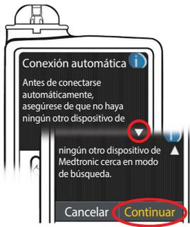
11. Lea la pantalla de la bomba. Asegúrese de que otros dispositivos de Medtronic NO estén en modo de búsqueda. Utilice la flecha hacia abajo para desplazarse a la página siguiente. Utilice los botones de las flechas para desplazarse hasta **Continuar**. Pulse el botón Seleccionar.
