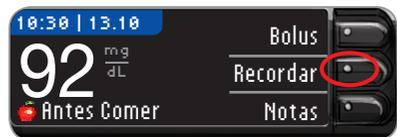
1. Con la tira reactiva aún en el medidor, pulse **Recordar**.
