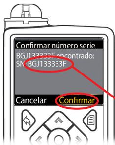
12. Compruebe que el SN (número de serie) en la pantalla de la **bomba** coincide con el SN (número de serie) del **medidor** en la pantalla del **medidor**.
